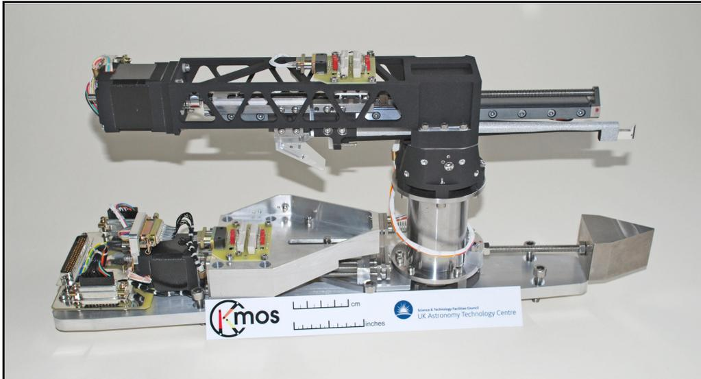
**Figura 2-28 Brazo robot criogénico para el posicionado de fibras de KMOS.**
