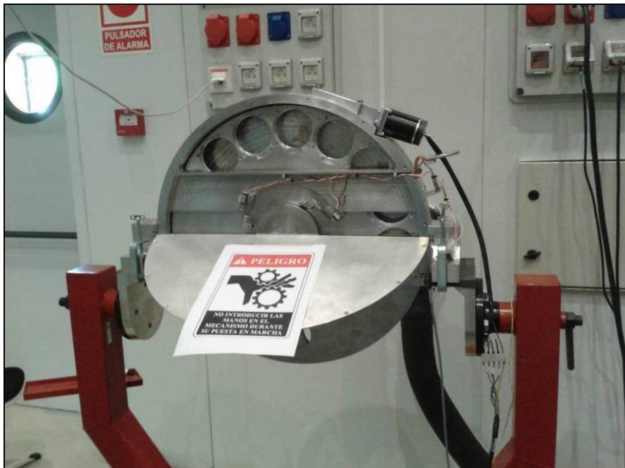
**Figura 5-33** La rueda de filtros durante las pruebas a temperatura ambiente.
