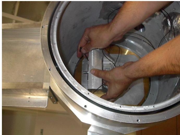
**Figura 4-39** Integración de la parte fría (discos de freno en estructura soporte) en el interior del banco de pruebas.
