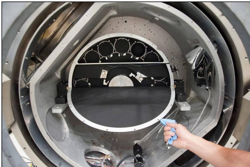
**Figura 6-1 Rueda de filtros pintada en Nextel durante el proceso de montaje en el criostato de pruebas. Falta por integrar el husillo y el motor criogénico.**
