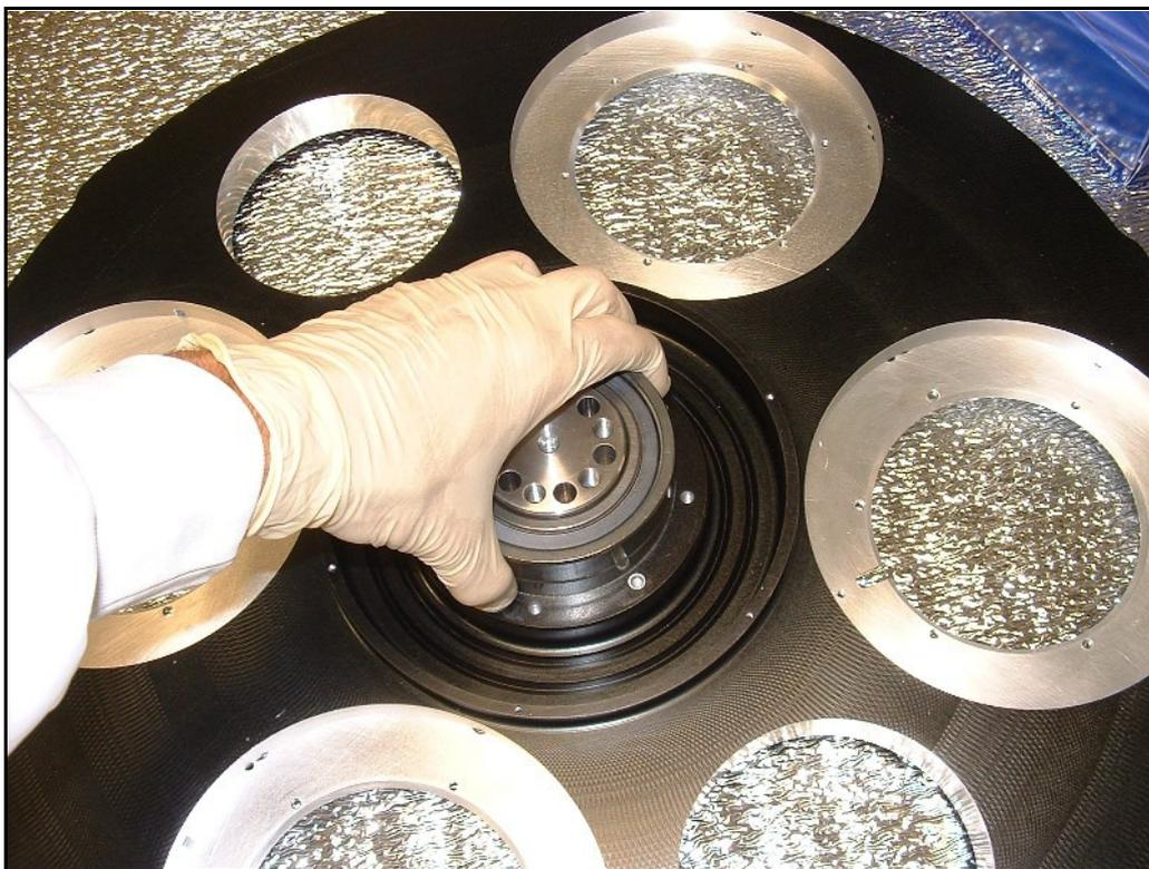
**Figura 4-56** Inserción de los rodamientos en el alojamiento del disco de la rueda de grismas.
