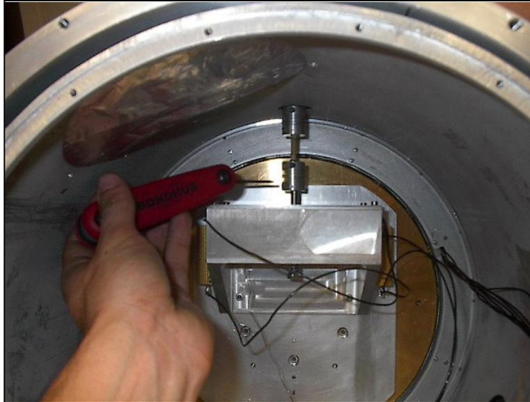
**Figura 4-40** Ensamble de los acoplamientos flexibles entre la parte fría del banco y el eje al exterior.
