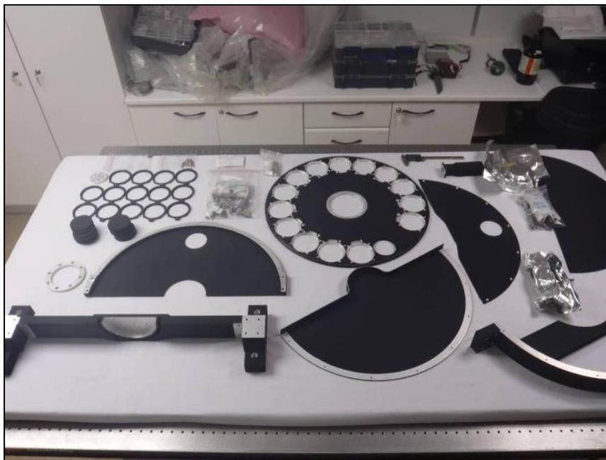
**Figura 5-47 Componentes de la rueda de filtros pintados y listos para su integración.**
