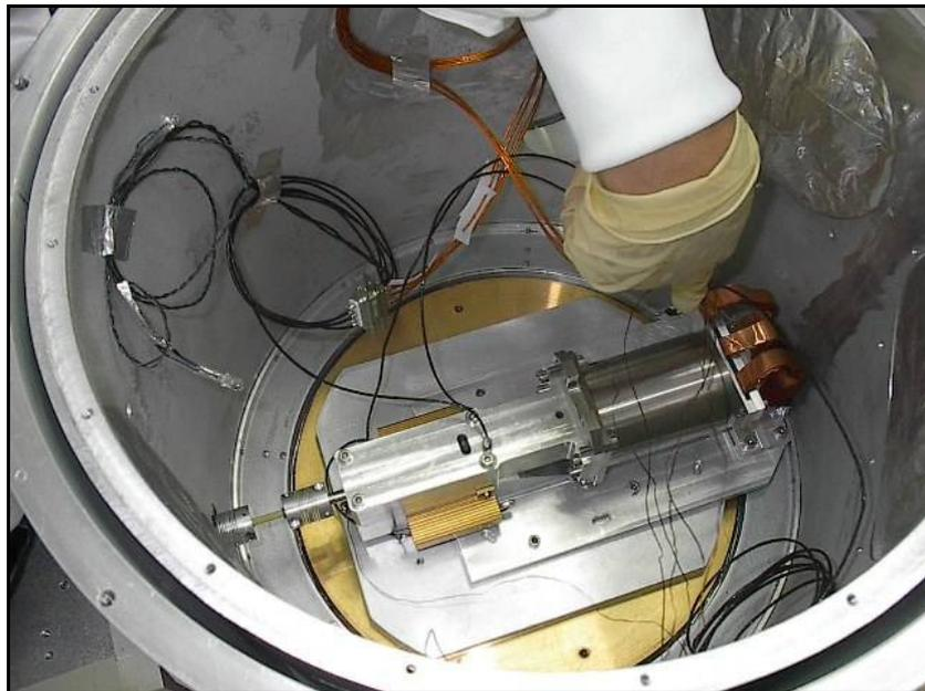
**Figura 4-21** Vista del interior del banco de pruebas. Se aprecia la placa de enfriamiento trasera del motor (señalada con la mano) y en el lado opuesto, un acoplamiento aislante con una varilla de fibra de vidrio.
