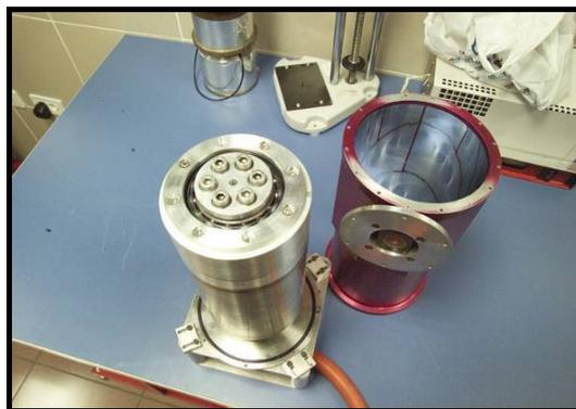
Figura 4-12 Banco de pruebas de los rodamientos.
