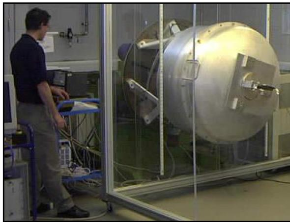
**Figura 2-30 Banco de pruebas definitivo con criogenia, vacío y orientación similares a las del instrumento final.**
