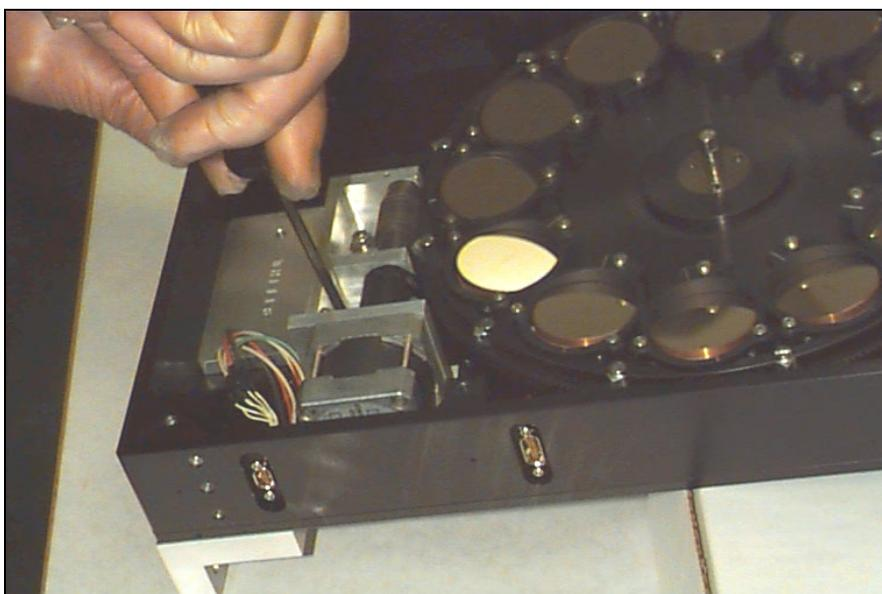
**Figura 2-12 Instalando el husillo en una de las ruedas de NIRSPEC.**
