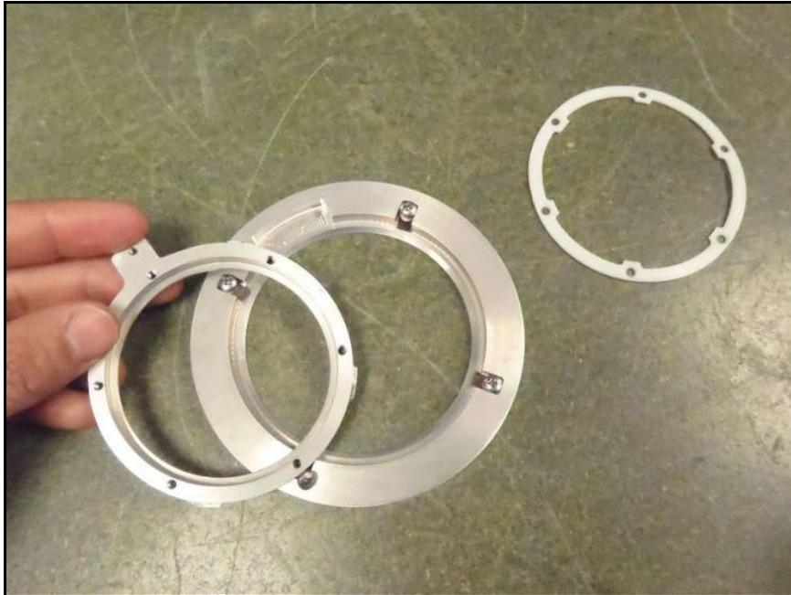
Figura 4-64 Prototipo del sistema de sujeción de los filtros en la rueda de filtros.
