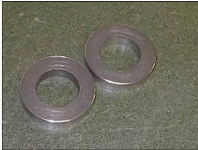
**Figura 4-43 Discos de Al6061 recubiertos de Nituff tras las medidas de par en condiciones ambientales.**
