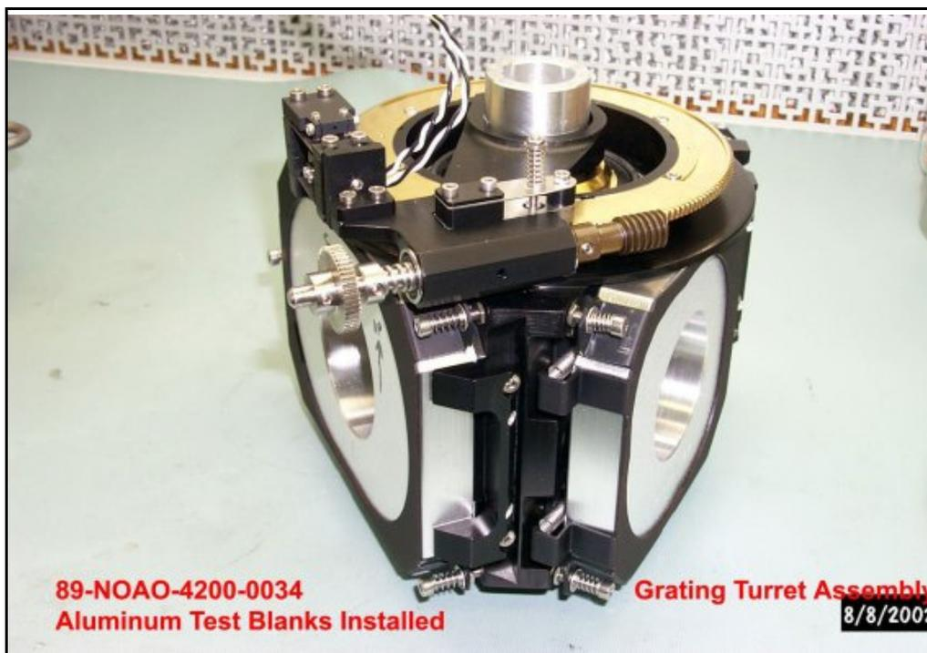
Figura 2-22 Ensamblaje de la "*grating turret*" de GNIRS.
