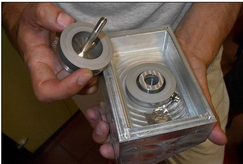
**Figura 4-46** Los discos de Al 6061T6 tras las pruebas a temperaturas criogénicas. Nótese cómo la superficie desgastada no coincide con la superficie total enfrentada.
