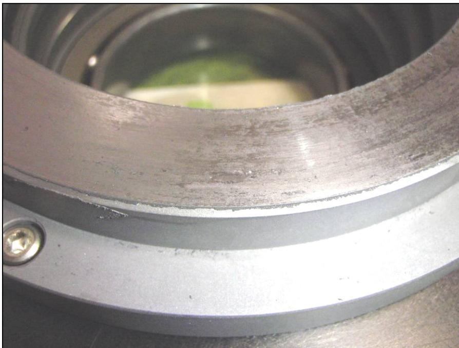
**Figura 5-25 Anillo de Keronite dañado en un punto.**
