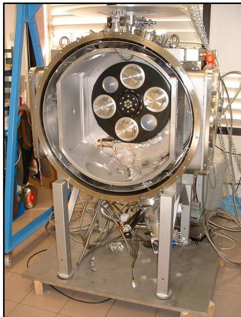
**Figura 4-62 Vista general del criostato de pruebas con el prototipo de la rueda de grismas.**
