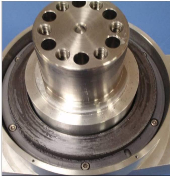
**Figura 5-21 Eje central de acero y anillo inferior de Keronite.**
