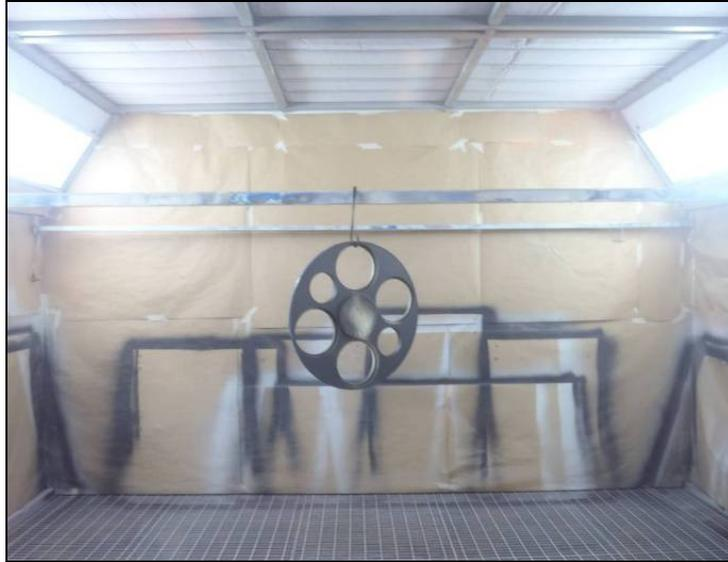
**Figura 5-46 Pintado con Nextel del disco de la rueda de grismas en la cámara de pintura.**
