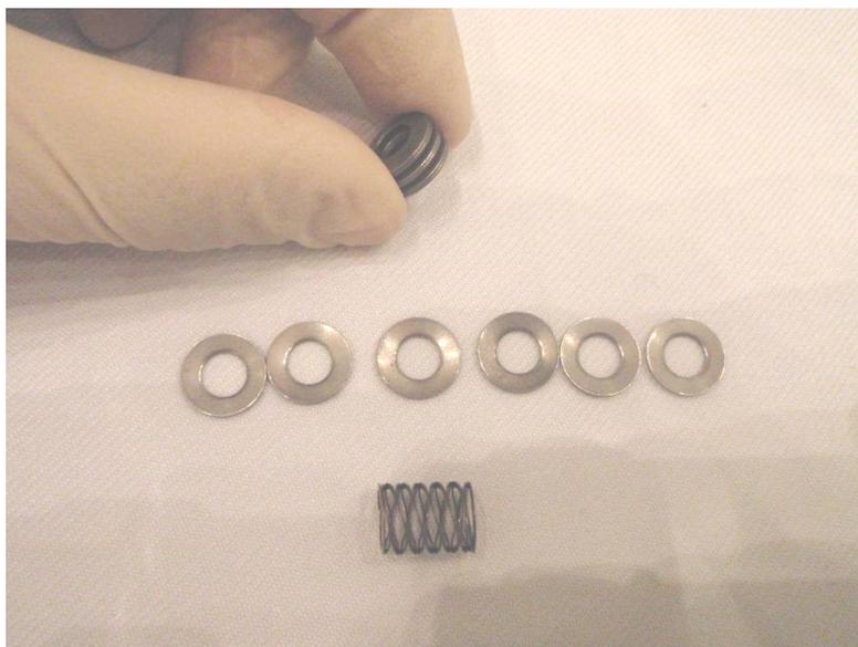
**Figura 4-9 Anillas de precarga apiladas (LIRIS) frente a muelles de cobre-berilio de la casa Smalley.**
