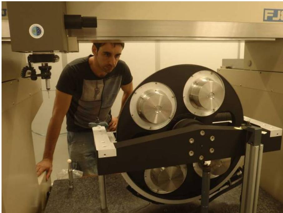
**Figura 6-9** La rueda de grismas sin carcasa, en la máquina de medición por coordenadas.
