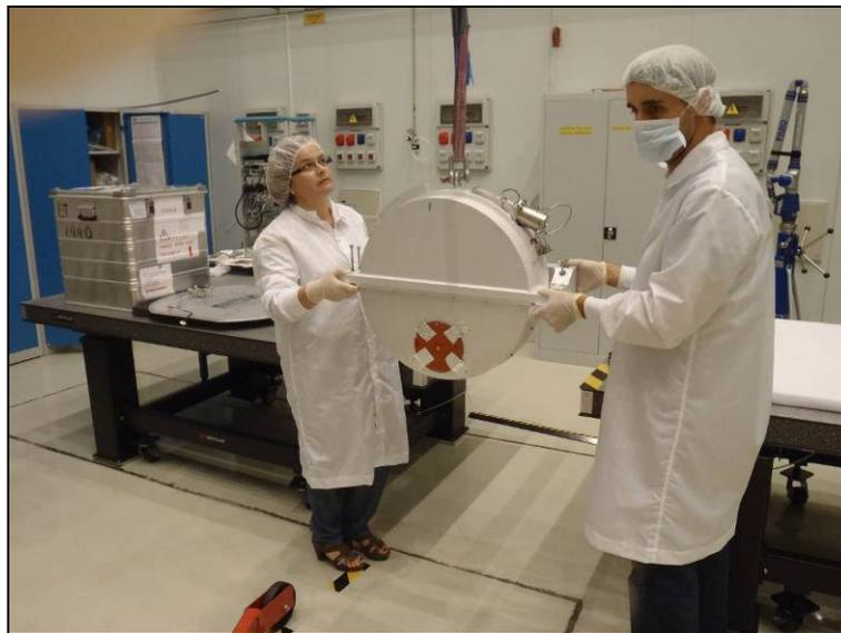
**Figura 5-29 Integración de los grismas en la rueda de grismas para validación de enfriamiento (II).**
