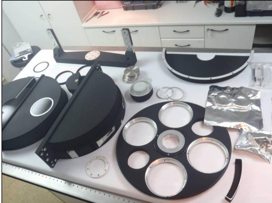
Figura 5-48 Componentes de la rueda de grismas pintados y listos para su integración.
