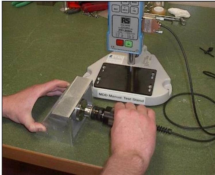
**Figura 4-36** Medición del par de frenado en condiciones ambientales.
