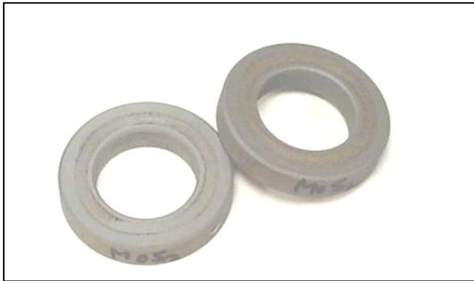
**Figura 4-49 Los discos tratados con Keronite+MoS<sub>2</sub> tras las pruebas.**
