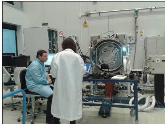
Figura 5-34 Rueda de filtros montada en el criostato de pruebas con dianas de apuntado.
