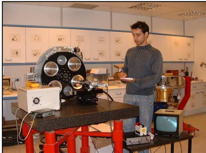
**Figura 4-60 Pruebas del prototipo de la rueda en condiciones ambientales. Un telescopio de alineado permite visualizar en una pantalla de televisión la posición de un retículo instalado sobre la rueda.**
