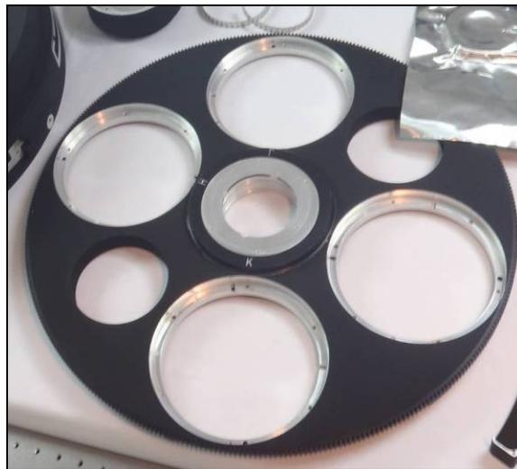
**Figura 6-5** Disco de la rueda de grismas donde se aprecian los cuatro planos de asiento H, J, K y convencional.
