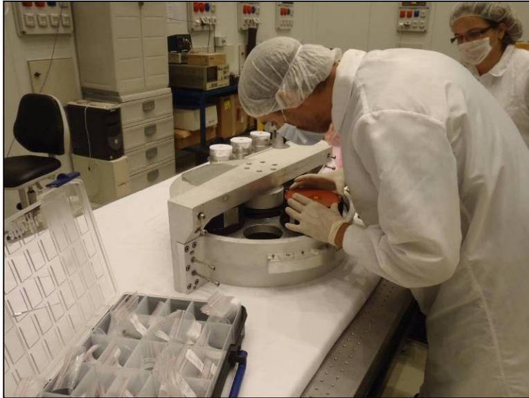
**Figura 5-28 Integración de los grismas en la rueda de grismas para validación de enfriamiento (I).**
