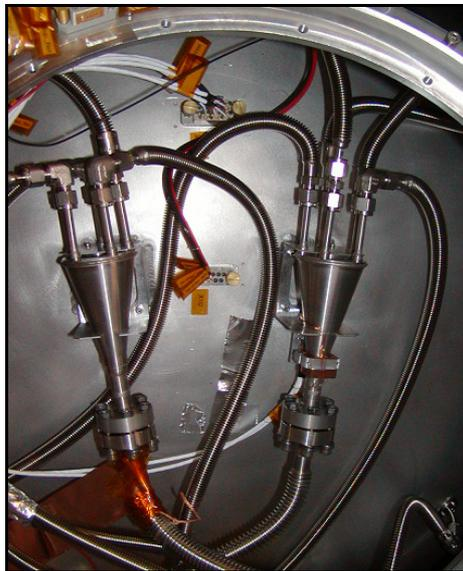
**Figura 2-31** Sistema de refrigeración interna de CRIRES por medio de conducciones de nitrógeno líquido distribuidas por la masa fría del instrumento.
