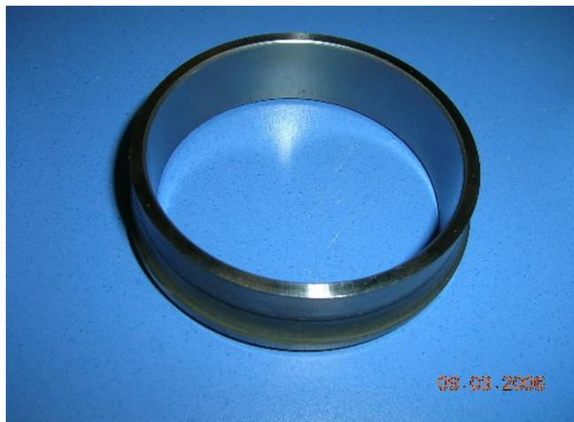
**Figura 4-15** Pista interior del rodamiento en AISI 440C de Champion (sin oxidación). Aún no expuesto a baño de alcohol isopropílico. Expuesto a condiciones ambientales por más de 4 meses desde su recepción en el IAC.
