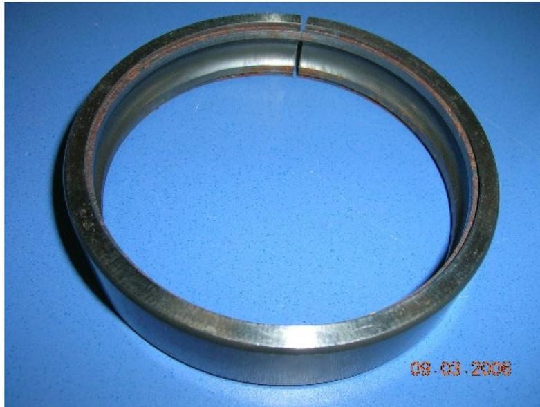
**Figura 4-16** Pista exterior del rodamiento en AISI 440C de Champion (oxidación en varias zonas, no en la zona de rodadura). Expuesto a baño de alcohol isopropílico. Expuesto a condiciones ambientales por más de 4 meses desde su recepción en el IAC.
