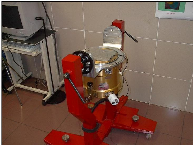
**Figura 4-37** Criostato del banco de pruebas: tanques de nitrógeno líquido y base fría.
