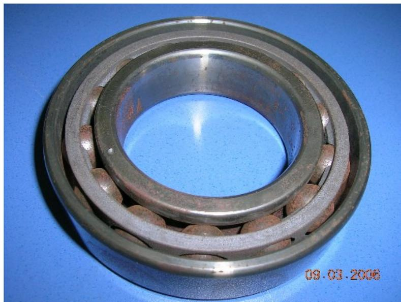
**Figura 4-17** Rodamiento en 100Cr6 de FAG (muy oxidado). Aún no expuesto a baño de alcohol isopropílico. Expuesto a condiciones ambientales por más de 4 meses desde su recepción en el IAC.
