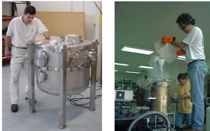
**Figura 2-3** Criostato de LIRIS (izquierda) y enfriamiento del criostato de pruebas del detector de LIRIS (derecha), con Nitrógeno Líquido (77 K, -196 °C).
