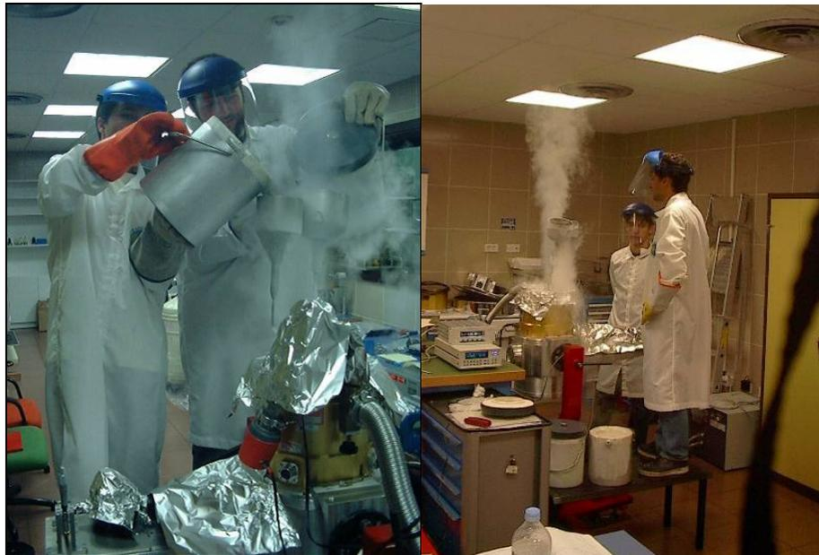
Figura 4-42 Enfriamiento del banco de pruebas por medio de nitrógeno líquido vertido en los tanques.
