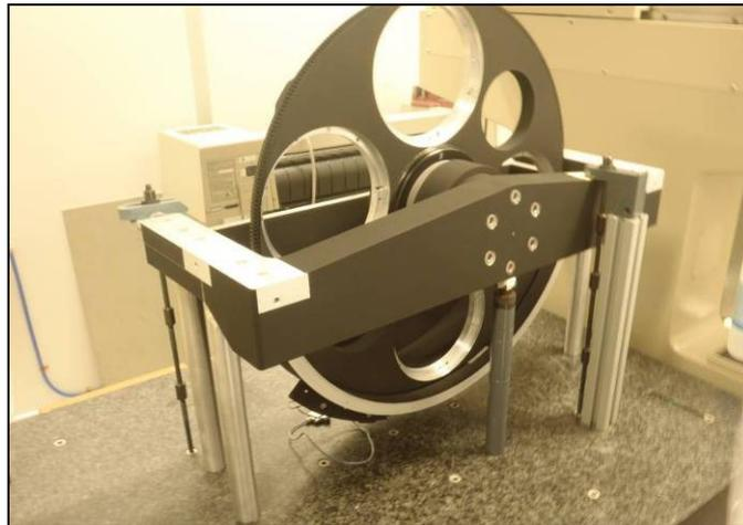
**Figura 6-6 Rueda de grismas en la máquina de medición por coordenadas.**
