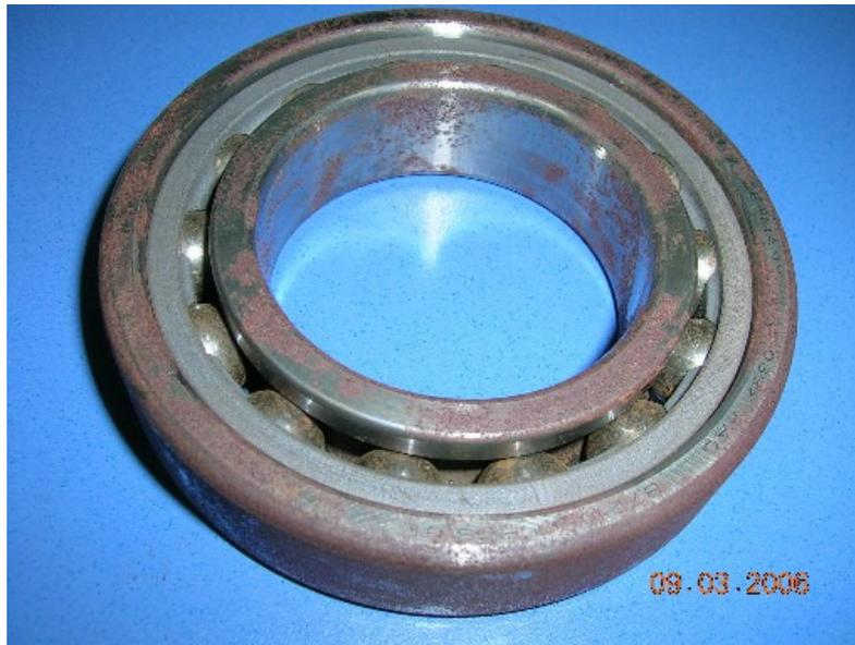
**Figura 4-18** Rodamiento en 100Cr6 de FAG (extremadamente oxidado). Expuesto a baño de alcohol isopropílico y reposo sobre superficie de aluminio. Expuesto a condiciones ambientales por más de 4 meses desde su recepción en el IAC.
