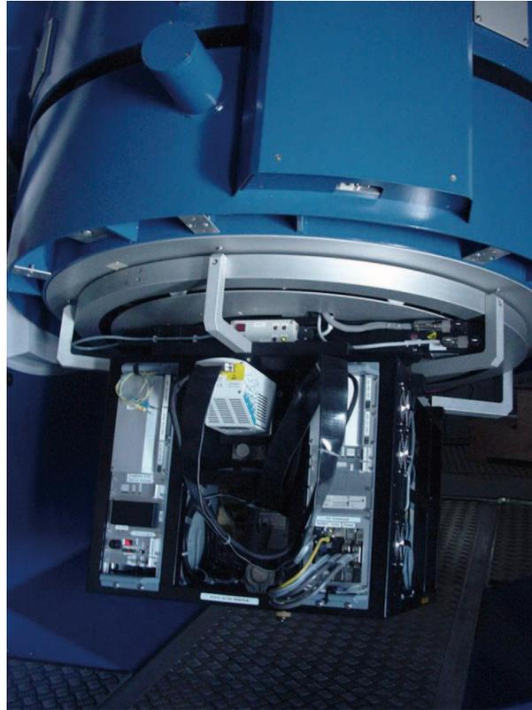
Figura 2.2: CCD **MEROPE** situada en el foco Cassegrain del telescopio **MERCATOR**
