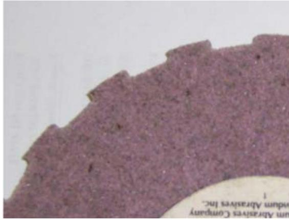
Figura 4.1: Perfil de una muela dentada.
