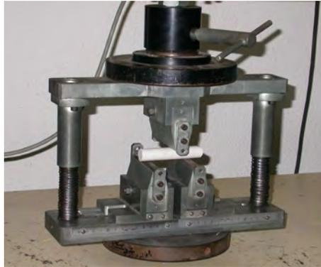
Figura 1: Ensayo de flexión en tres puntos.
