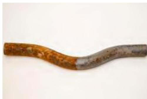
Figura 5. La zona izquierda de este acero está corroída, pero la derecha ha sido tratada con una disolución de pertecnetato, lo que ha conseguido inhibir dicha corrosión.
