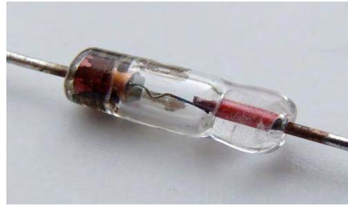
Figura 4. El diodo de germanio reemplazó al tubo de vacío y la galena en las radios.
