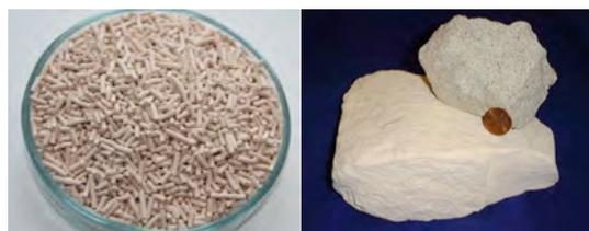
Figura 3: Fotografías de dos zeolitas, una sintética (izquierda) y otra natural (derecha)<sup>2</sup>.
