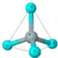
Figura 2: Estructura tetraédrica básica de las zeolitas.
