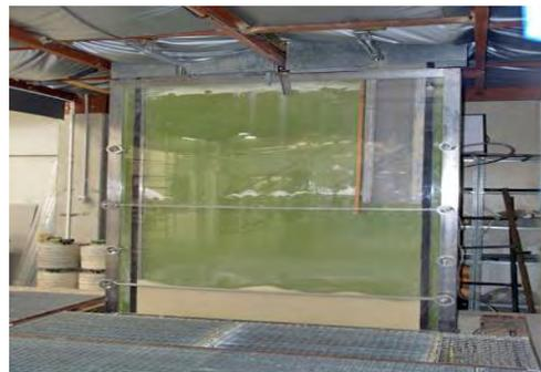
Figura 4. Reactor de lecho fluidizado. Fuente: Instituto de CarboQuímica, CSIC
