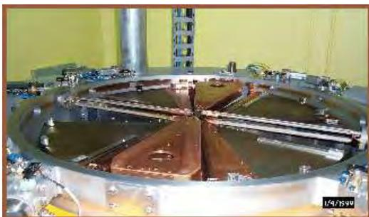
Figura 1. Un ciclotrón, acelerador de partículas circular que consigue acelerar los iones haciéndoles girar en órbitas de radio y energías crecientes.
