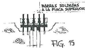
Dichos gatos se apoyaban sobre unas placas de acero conformadas previamente con escuadras laterales para evitar deformaciones y soldadas a la cabeza del pilote.
