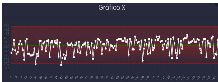
Figura 5. Gráfico de control X altura generada en el software
