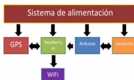
Figura 3. Sistema de alimentación del Bloque
