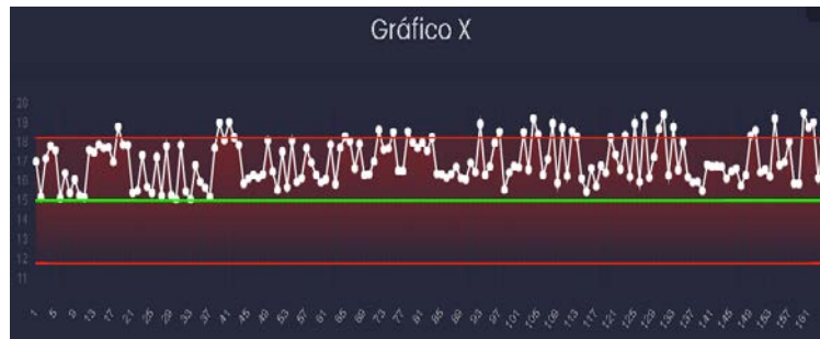
Figura 8. Gráfico de control X peso generado en el software
