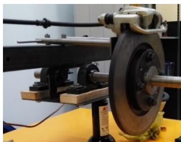
Figura 4. Conjunto disco-mordaza del banco de pruebas
