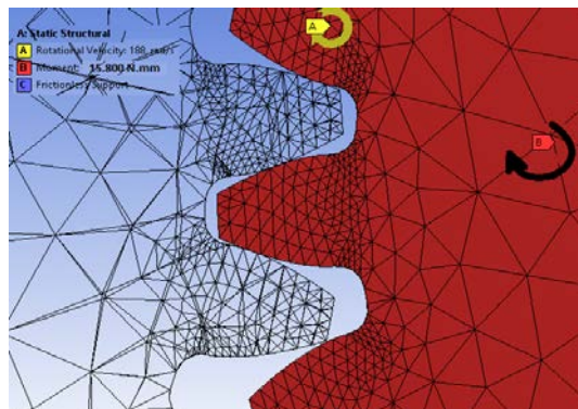
Figura 6. Modelo FEA y mallado de un par de engranes en contacto
