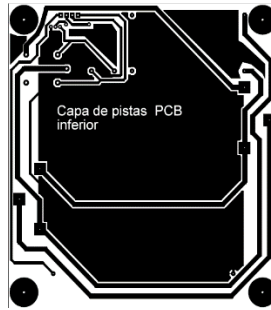
Figura 4. Diseño en board de la etapa de potencia
