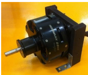
Figura 1. Motor Turnigy Rotomax 80cc acoplado a la bancada
