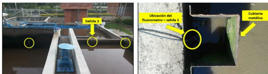
Figura 12. Punto de medición de la sustancia trazadora (salida 1)
