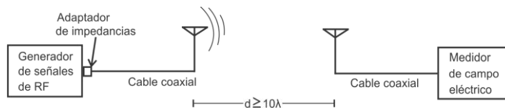
Figura 20. Montaje para estimación de ganancia de antena
