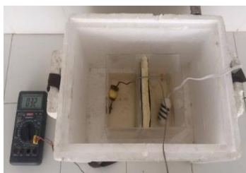
Figura 10. Estudio de conductividad térmica en las paredes aislantes
