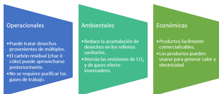
Figura 89. Algunas ventajas del proceso de pirólisis [3,16,17]
