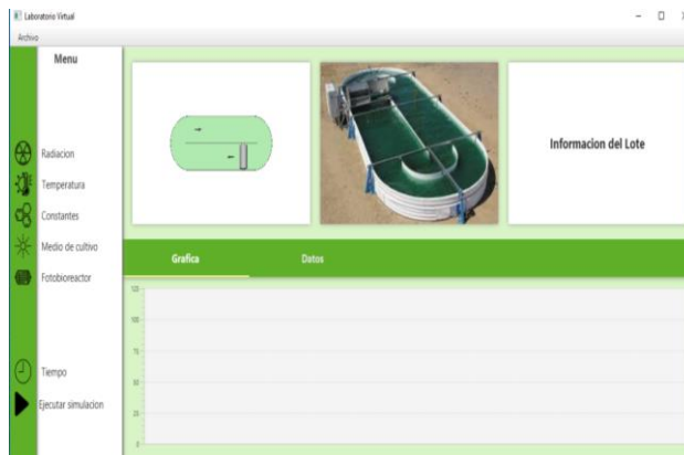
Figura 2. Interfaz gráfica del laboratorio virtual para el proceso de producción de Spirulina
