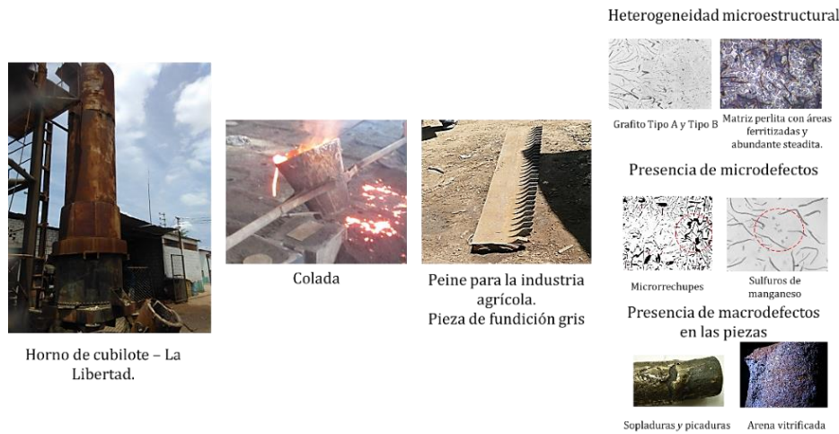
Figura 1. Proceso de fundición del norte. Diagnóstico de los principales problemas encontrados en cuando a calidad
