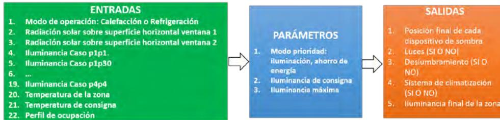
Figura 3. Parámetros, entradas y salidas del modelo de control de persianas.
