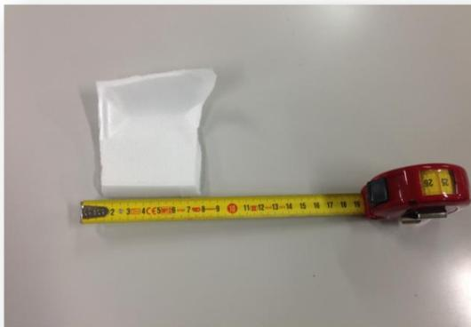
**Figura 2.** Muestra de poliestireno extruido (XPS) después del proceso de triturado.
