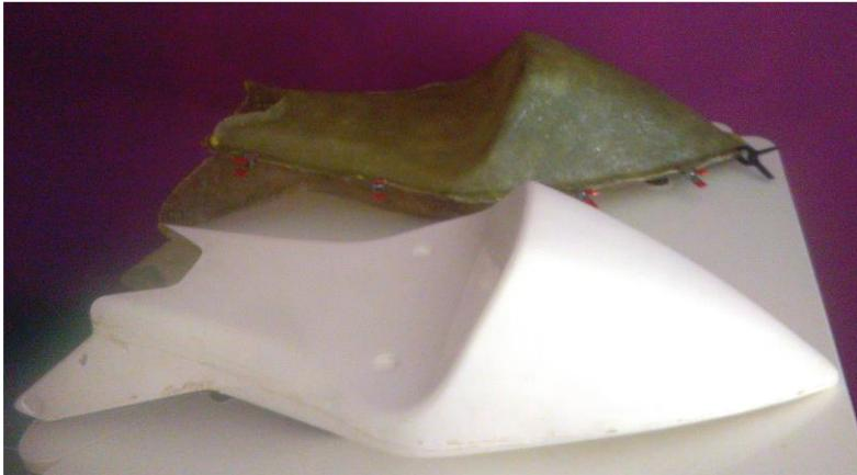
**Figura 9.** Colín fabricado con basalto y epoxi junto con el molde utilizado.
