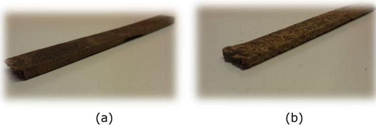
**Figura 3.** (a) Probeta normalizada elaborada por termo compresión, empleando pinocha micronizada. (b) Probeta normalizada elaborada por termo compresión, empleando pinocha en fibra triturada.
