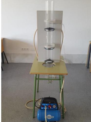
**Figura 6.** Equipo de resistencia al flujo.
