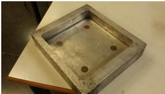
**Figura 2.** Molde para termoconformado.
