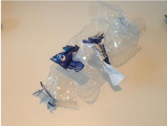
**Figura 1.** Muestra de polietileno de tereftalato (PET) después del proceso de triturado.
