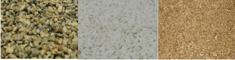
**Figura 1.** A) Arlita, B) Perlita, C) Vermiculita.
