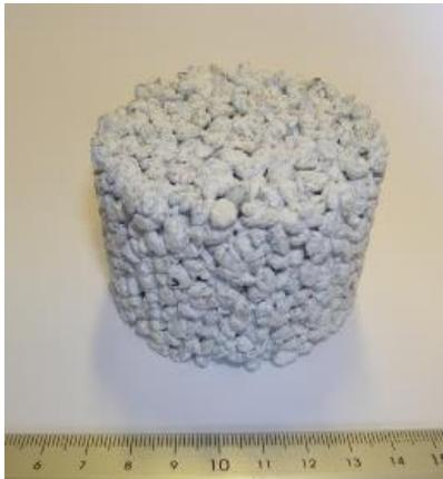
**Figura 1.** Probeta de material granular de matriz cementicia con arlita.
