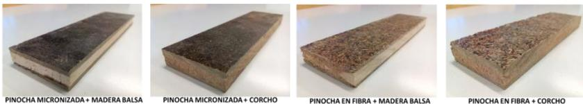
**Figura 4.** Paneles sándwich basados en las mezclas 70-30 de resinas ELO y GREENPOXY y pinocha en formato polvo y fibra.
