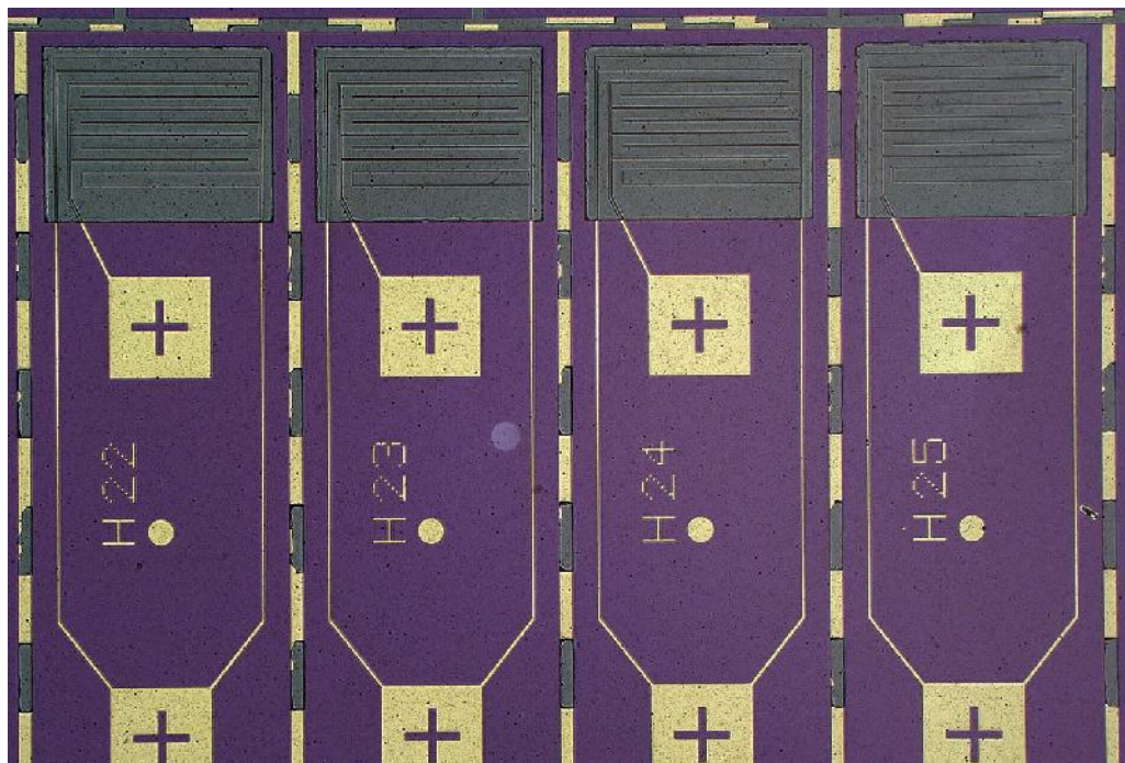
Figura 3-8. Detectores de PbSe para infrarrojo medio depositados sobre un filtro interferencial paso banda (imagen en color real). Proyecto CANARIO (Fuente: CIDA/ITM - Ministerio de Defensa)
