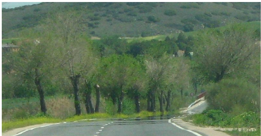
Figura 3-15. Reflejo en el asfalto producido por el cambio en el índice de refracción debido a un gradiente de temperatura (Fuente: el autor del capítulo)
