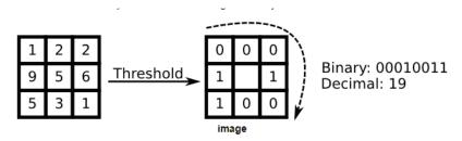
Figura 2. Ejemplo de cómo funciona el algoritmo LBPH con 8 pixeles. Fuente: [3]
