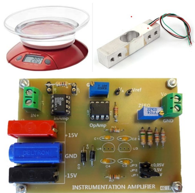
Fig. 3. Práctica de Amplificador de Instrumentación. Celda de carga. Circuito electrónico para balanza
