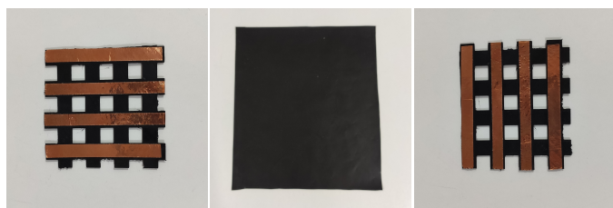
Fig. 1. Despiece de la malla de presión matricial. Por orden (de izquierda a derecha): capa de filas, material piezorresistivo Velostat y capa de columnas.
