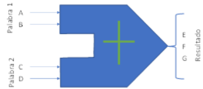
Fig 3. Representación de la ALU sumadora de dos palabras de dos bits
