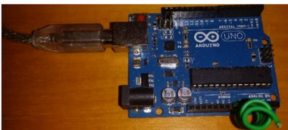
**Figura 3.** Aspecto final de la placa y la antena inductiva.
