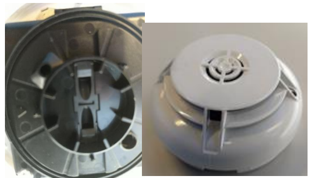
Fig. 2. Ejemplo de aplicación de led y fotodiodos. Sensor de humos del aula.
