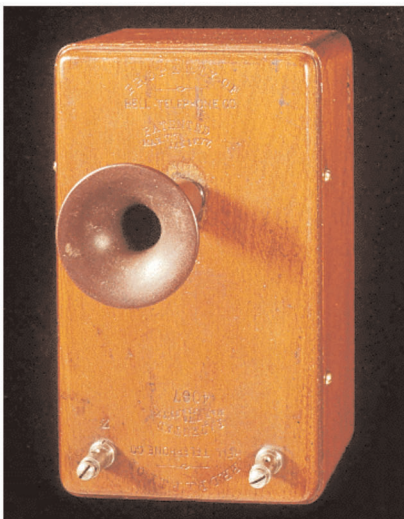
Figura 4. Teléfonos de Bell de 1877. Izquierda, fotografía de un box telephone de la Smithsonian Institution, que responde a la descripción del utilizado por los Bomberos del Comercio de Cuba. Derecha, corte longitudinal del band telephone presentado por Bréguet a la Academia de Ciencias de París ( Comptes rendus hebdomadaires des séances de l'Académie des Sciences , tomo 85, pág. 777). El segundo fue una versión simplificada del primero, aparecida algunos meses después.
