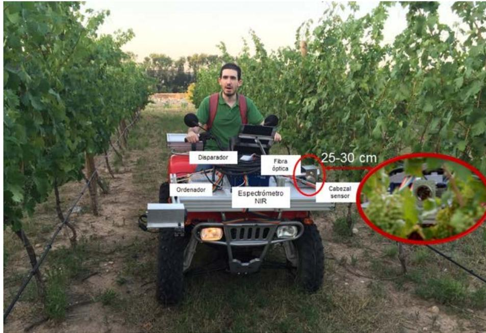
Fig. 1. Ilustración del equipo NIRs y sus componentes, para adquisición de espectros en continuo de la vegetación del viñedo desde un vehículo móvil.
