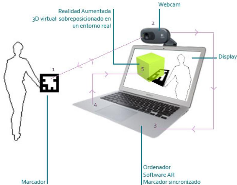
Figura 5. Esquema de funcionamiento básico de la RA.
