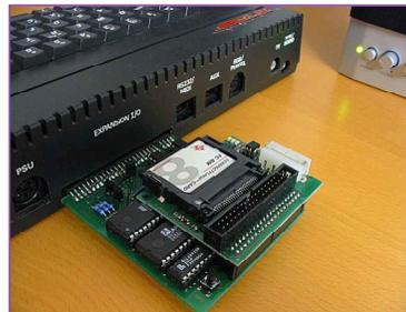
Figura 6. Ordenador Sinclair Spectrum con hardware adicional para la lectura de ROMS (fuente: [http://www.elotrolado.net/hilo\\_xz-spectrum-la-joya-de-la-corona\\_535050](http://www.elotrolado.net/hilo_xz-spectrum-la-joya-de-la-corona_535050))
