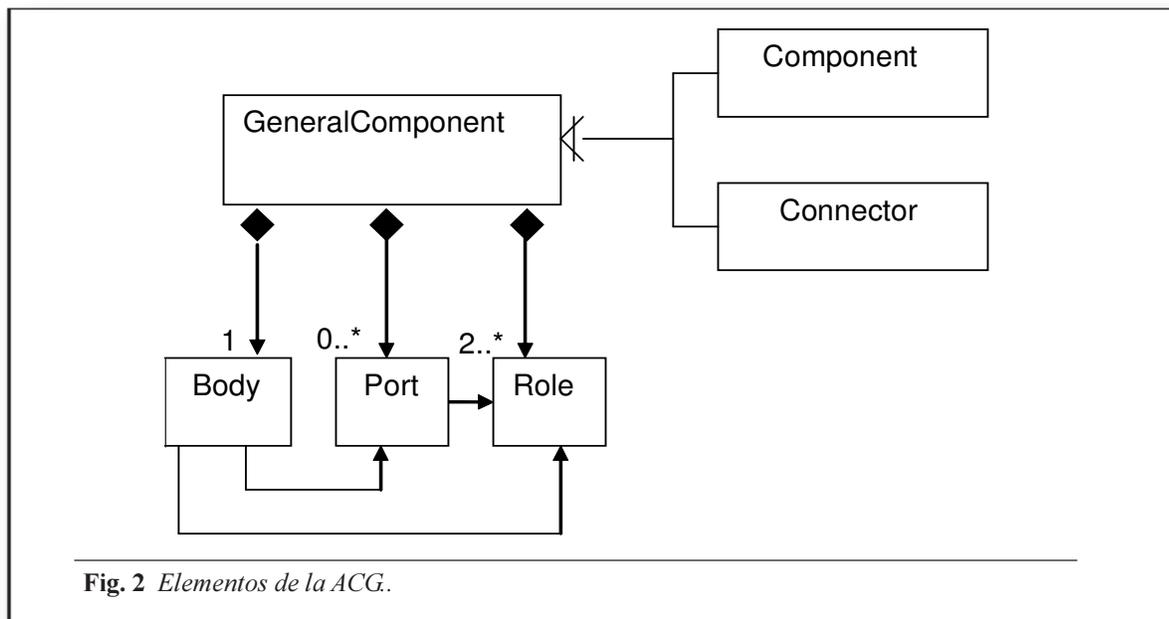
Los componentes y conectores de la ACG pueden ser vistos como clases desde el punto de vista de la programación orientada a objetos, sin embargo, tampoco la metaclassa clase (*Class*) es adecuada porque, aunque su definición en el paquete *StructuredClasses* del metamodelo de UML, puede tener elementos internos (necesarios para la especificación de diagramas según ACG), también tiene puertos y estos son incompatibles con los puertos de la ACG, como se explicó.
