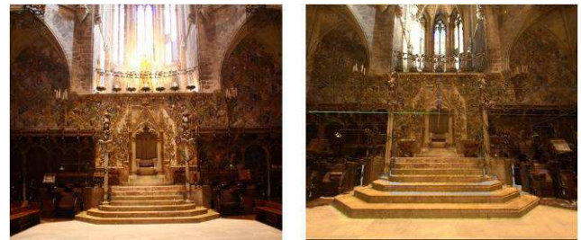
Fig. 5. Comparativa de una toma real obtenida mediante fotografía (imagen izquierda) con una toma virtual mediante escaneo láser 3D (imagen derecha).
