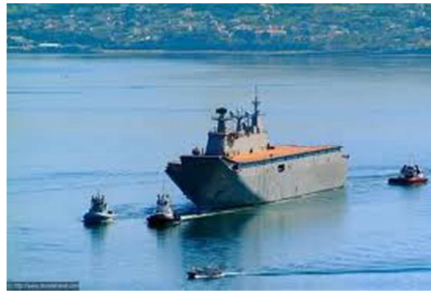
Figura 23. Buque siendo remolcado por tres remolcadores de puerto (Fuente: Google imágenes)
