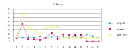
Fig. 9. Comparación del consumo de CPU con 15 hilos
