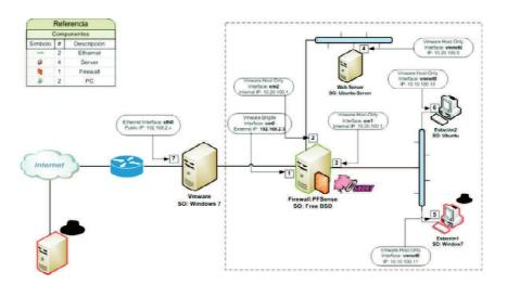
Fig. 1. Diseño para la generación y mitigación de ataques UDP Flood
