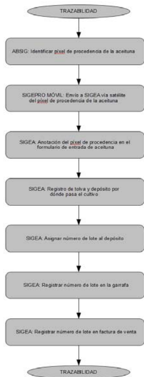
FIGURA 11: DIAGRAMA DE FLUJO DE DATOS DEL CONTROL DE LA TRAZABILIDAD EN NUESTRO PROTOTIPO
