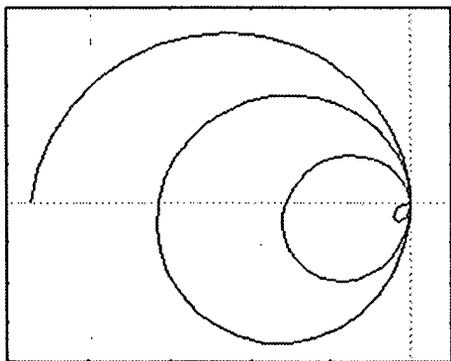
OR =  $d(\beta)$ , tomando el origen de  $\beta$  en el semieje X negativo y su crecimiento en sentido anti-reloj. La curva obtenida para  $k = 1$ , es la figura 3, lugar geométrico del punto R al girar el dispositivo desde  $\beta = 0^\circ$  hasta  $\beta = 540^\circ$
