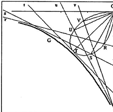
Figura 5.- Construcción de la curva directriz como envolvente de un conjunto de rectas
