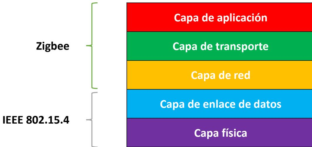
Figura 2.4 Pila de protocolos de una WSN.
