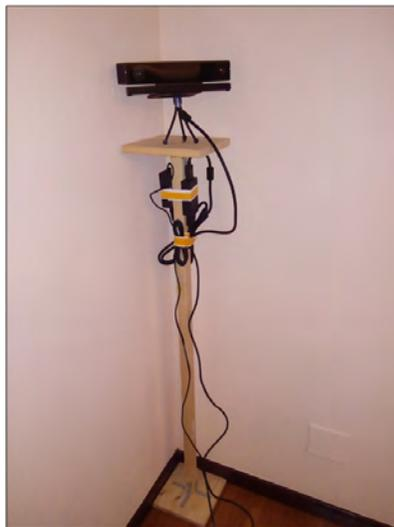
Figura 5.16: Sensor Kinect montado en una plataforma de madera
