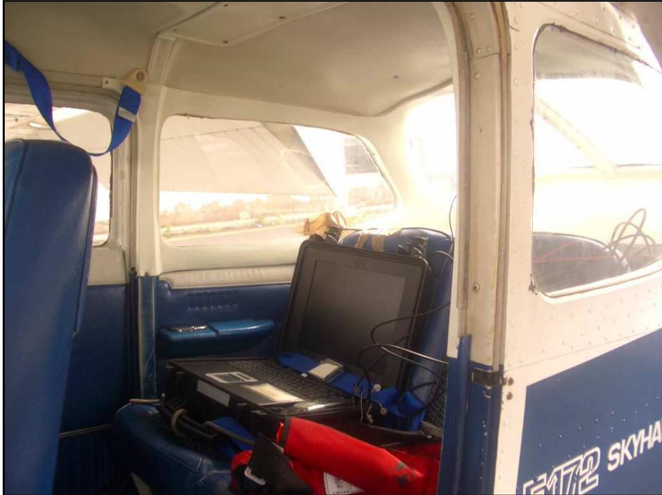
**Figura VII. 24** Sujeción del equipo de medidas
