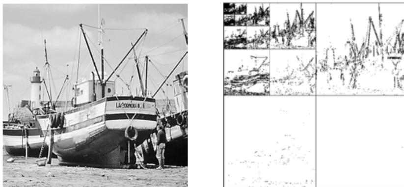
Figura 3: A la izquierda, la imagen original. En cada imagen pequeña de la derecha, los puntos oscuros son los coeficientes de las ondículas con amplitud grande, en una escala y orientación particulares. La mayoría de los coeficientes son cero (blanco), que es por lo que la compresión se realiza con muchos menos bits que la cantidad de píxeles de la imagen original. Fuente: figura 2 en [13, pág. 1385].
