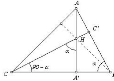
El ángulo  $\angle HAC'$  es igual al ángulo  $\angle A'AB$  del triángulo  $A'AB$  que es rectángulo, por tanto el ángulo  $\angle A'BA$  es  $\alpha$ .
