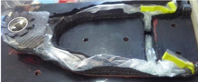
Figura 12. Posicionamiento de bolsa de vacío. Detalle pestañas de unión laterales y pestaña de unión en tija.
