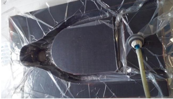
Figura 10. Laminado de la primera capa y compresión en bolsa de vacío.
