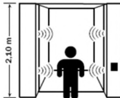
Figura 5- Elevadores com sensores em diversas alturas que permitam às pessoas entrarem sem riscos se a porta for fechada no meio do procedimento e escadas e rampas com corrimão
